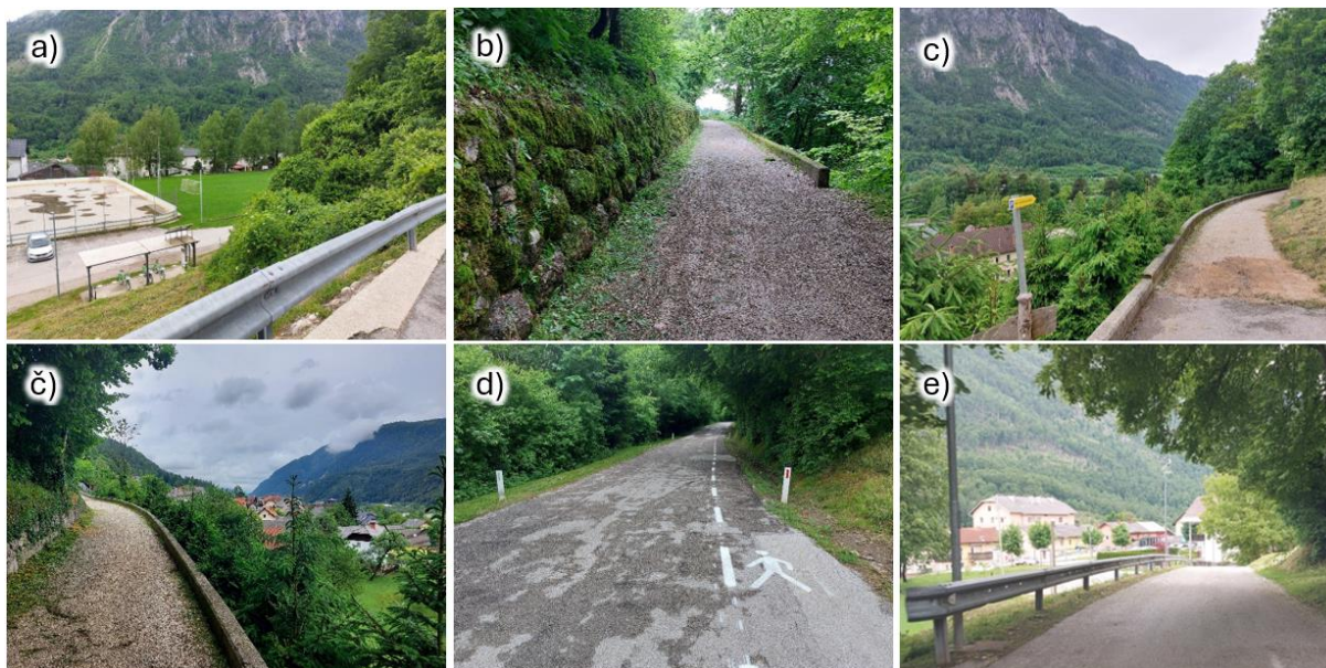
Slika 12: a) zaradi smiselnosti povezave predlagamo izgradnjo stopnic od športnega parka do ceste pri stanovanjskih blokih; b) pomembni element, ki naj se ohranja na trasi (je del identitete prostora) so kamniti zidci, tipične mulde in robniki ob poti; c-č) nujna je ohranitev nizke vegetacije ob spodnjih robovih poti za omogočanje panoramskih razgledov s poti; d-e) potrebna je izgradnja pločnika ob cesti ali omejitev hitrosti prometa na 30 km/h zaradi varnosti pešcev, predlagamo, da se trasa poti, ki bi (predvideno) potekala po lokalni cesti čez Kopavnik (slika d) uredi izven cestišča, vzporedno s cesto po brežini (enakomerni naklon, ambientalno privlačna in razgledna).
